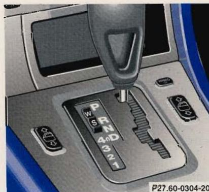
Le passage de rapports s'adapte automatiquement au style de pilotage du conducteur par déplacement des points de passage.
