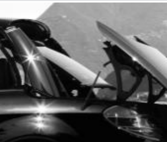
Toit escamotable à commande électrohydraulique ▼
